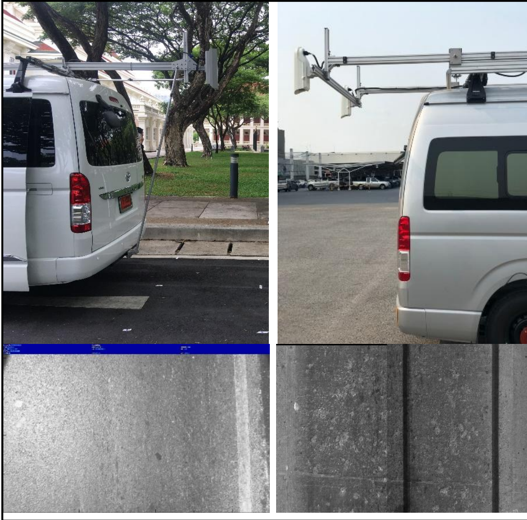
รูปที่ 4-6 กล้องบันทึกภาพผิวทาง และตัวอย่างภาพจากกล้องบันทึกภาพผิวทาง
